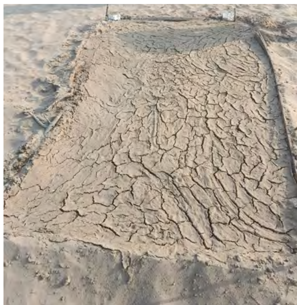
Рис. 2. Испытание био-нанокompозитных материалов в условиях пустыни
