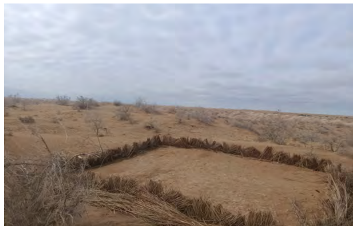
Рис.3. Апробация технологии закрепления песков методом внесения фототрофных микроорганизмов
